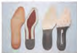
左:グッドイヤウエルト式製法 右:セメント式製法
